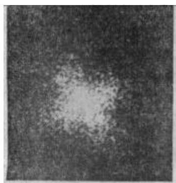
图 9 68^{\circ}\text{C} 时黄原胶水溶液的 H v 图 浓度: 3.5%
